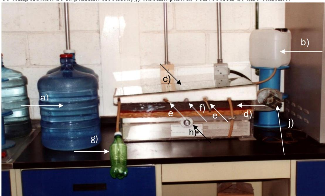
Para realizar los experimentos a la temperatura de trabajo, se utilizó una parrilla eléctrica marca Themolyne, con una longitud de 0.61 m de largo y 0.32 m de ancho y 0.055 m de altura media, completando un área de calentamiento del evaporador de 0.195 m<sup>2</sup>, la cual mantenía la temperatura constante de la muestra de agua subterránea dentro del prototipo. El condensador utilizado es vidrio comercial con un grosor de 3 mm.
