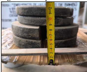
Figura 4: Ensayo de Resistencia a la Flexión
