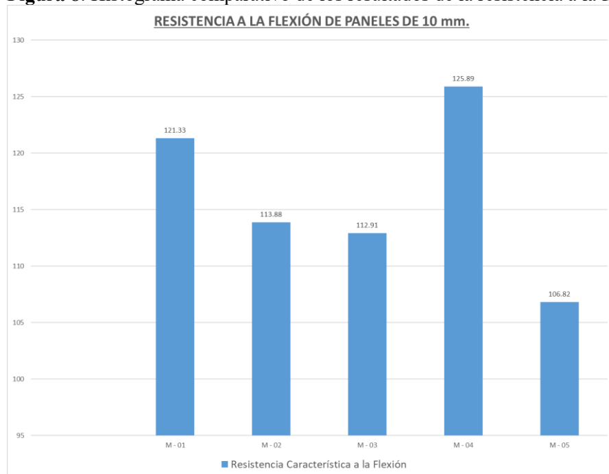
Figura 8: Histograma comparativo de los resultados de la resistencia a la flexión de paneles de 10 mm
