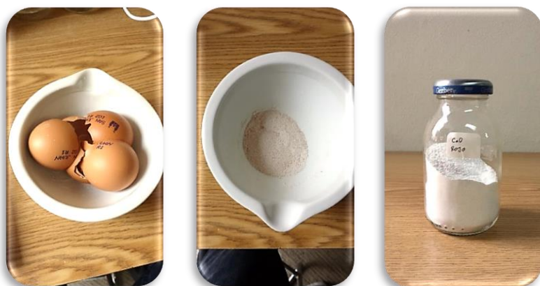
Figura 7.- Producción de óxido de calcio ( CaO ) con cascarones de huevo por calcinación.
