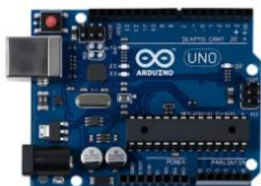
Figura 2. Arduino UNO R3.
