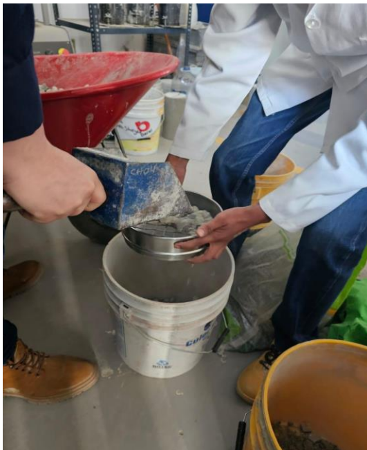
Figura 4. Proceso de tamizado para el análisis granulométrico de agregados gruesos. Fuente: elaboración propia.
