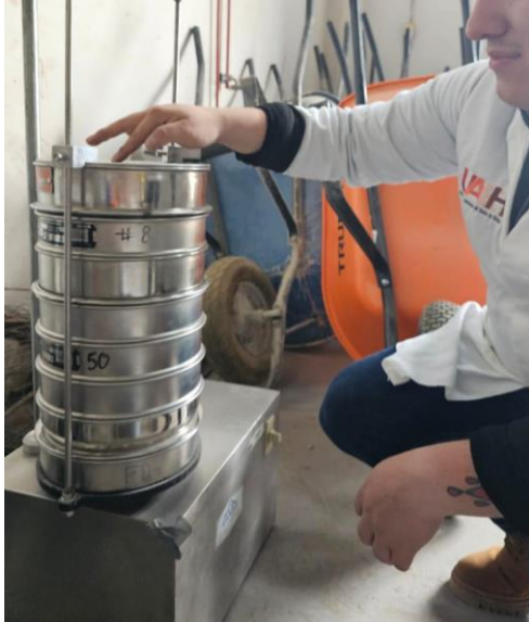
Figura 2. Proceso de tamizado para el análisis granulométrico de agregados finos. Fuente: elaboración propia.
