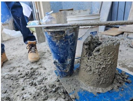
Figura 5. Proceso de prueba de revenimiento
