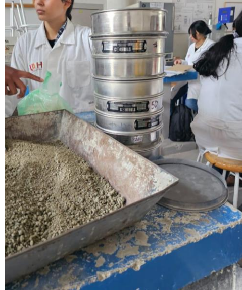
Figura 3. Tamices utilizados para la clasificación de agregados finos. Fuente: elaboración propia.
