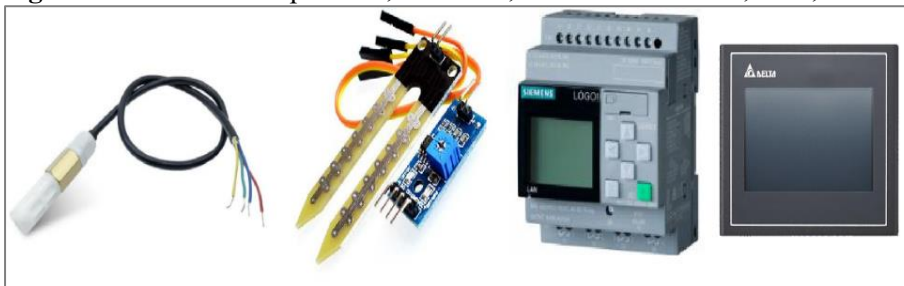
Figura 3. Sensor de temperatura, humedad, humedad del suelo, PLC, HMI del Sistema
