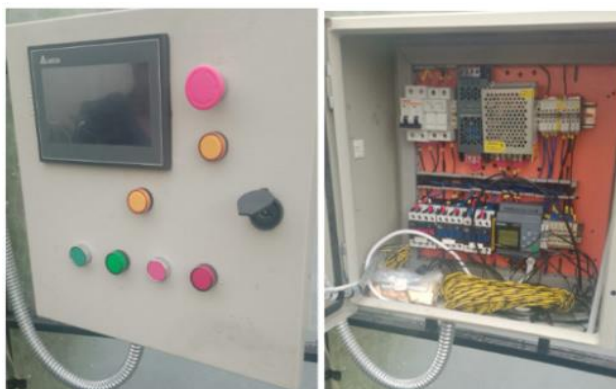
Figura 4. Sistema de control y potencia
