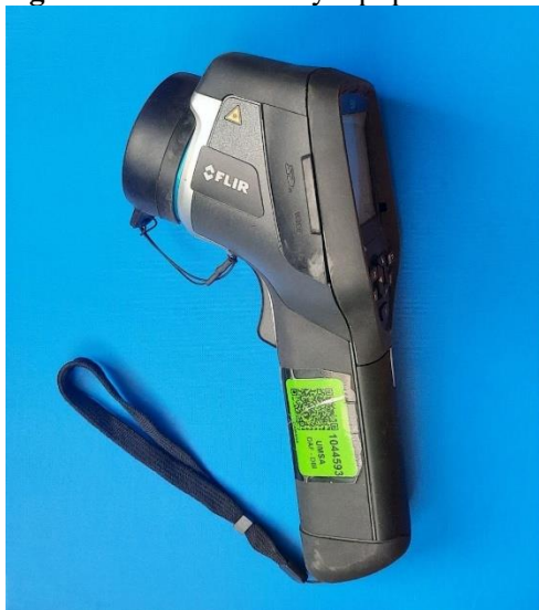
a) Cámara termográfica
