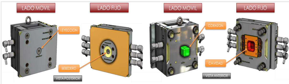
Imagen 7. Lado móvil y fijo del molde con sus respectivos insertos intercambiables de corazón y cavidad
