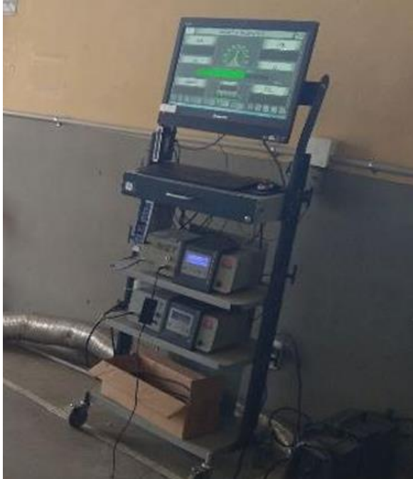
Figura 2. Analizador de gases de escape MAHA MET 6.1 utilizado en los ensayos experimentales 4
