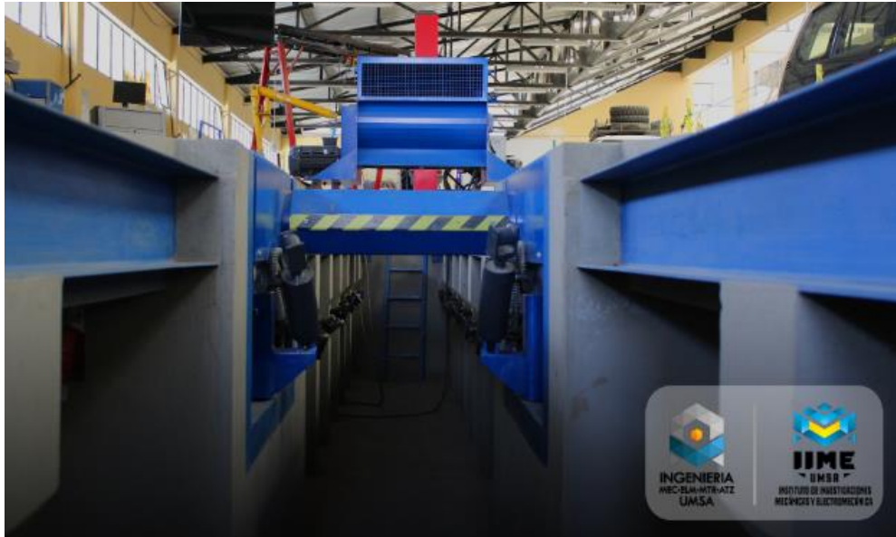
Figura 1. Instalación del dinamómetro de chasis LPS 3000 LKW en los laboratorios del IIME – UMSA. 3
