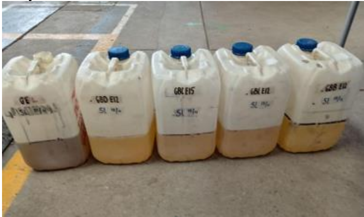
Figura 4. Dosificación volumétrica y acondicionamiento de las mezclas de combustible para los ensayos 6
